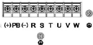
Рис 4.8 Силовые клеммы 004G/5R5P–5R5G/7R5P
