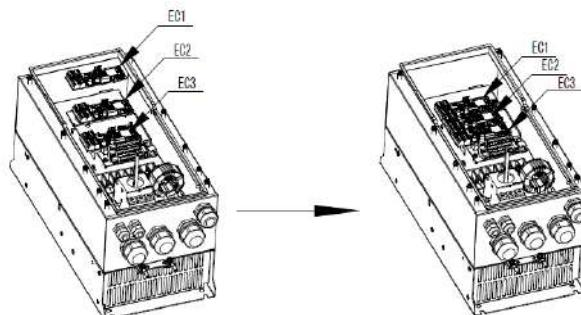
Рис А-1 ПЧ 7,5 кВт или выше с установленными платами расширения
