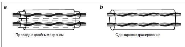
Для цифровых сигналов низкого напряжения рекомендуются кабели с двойным экраном, но также могут использоваться экранированные или неэкранированные витые пары (как показано на рисунке b). Однако для частотных сигналов можно использовать только экранированные кабели.
