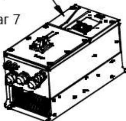
Рис А-2 Схема процесса установки платы расширения
