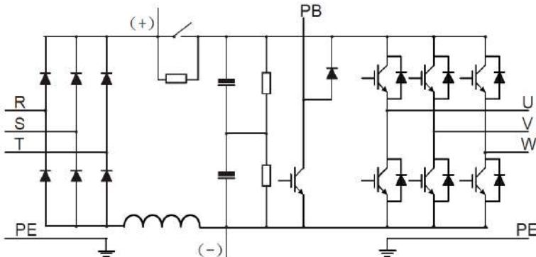
Рис 3.2 Схема силовой цепи моделей 018G/022P-110G (включательно)
