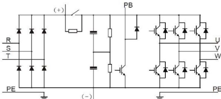
Рис 3.1 Схема силовой цепи моделей 015G/018P и выше
