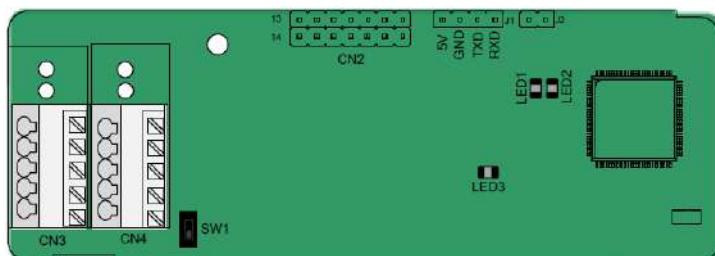
DIP-переключатель SW1 используется для установки класса напряжения (5 В или 12 В) источника питания энкодера. DIP-переключателем можно управлять с помощью вспомогательного инструмента.
