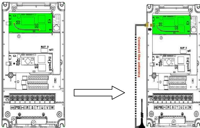
Карта беспроводной связи должна использоваться с приложением INVT Inverter APP. Отсканируйте QR-код паспортной таблички ПЧ, чтобы загрузить его. Подробнее см. в руководстве к плате беспроводной связи, прилагаемой к плате расширения. Основной интерфейс показан следующим образом.
