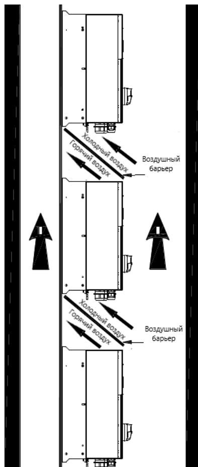
Рис 4.5 Вертикальная установка
