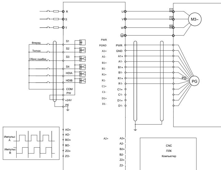
На следующем рисунке показана внешнее подключение PG-карты, когда она используется в сочетании с энкодером с CD-сигналами.
