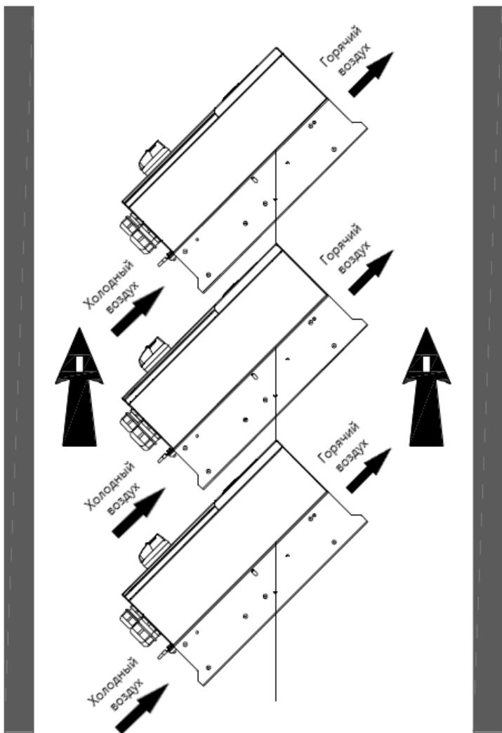
Рис 4.6 Наклонная установка
