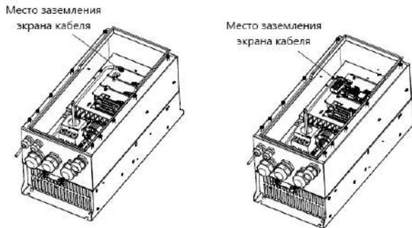
Рис A-3 Схема заземления платы расширения
