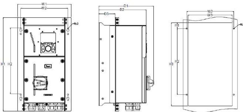
Рис С.3 Схема фланцевого монтажа ПЧ моделей 004G/5R5P-037G/045P
