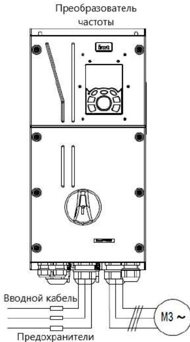
Рис 4.19 Подключение предохранителей
