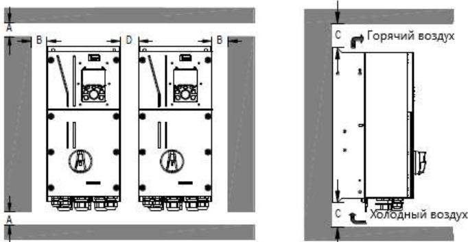
Рис 4.4 Параллельная установка
