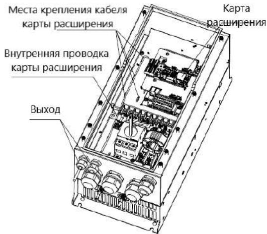
Рис A-4 Прокладка проводов платы расширения
