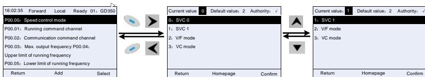
Рис. 15.15 Интерфейс редактирования выбора параметров
