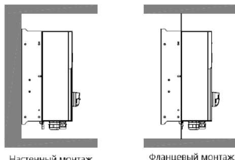
Рис 4.2 Способы установки
